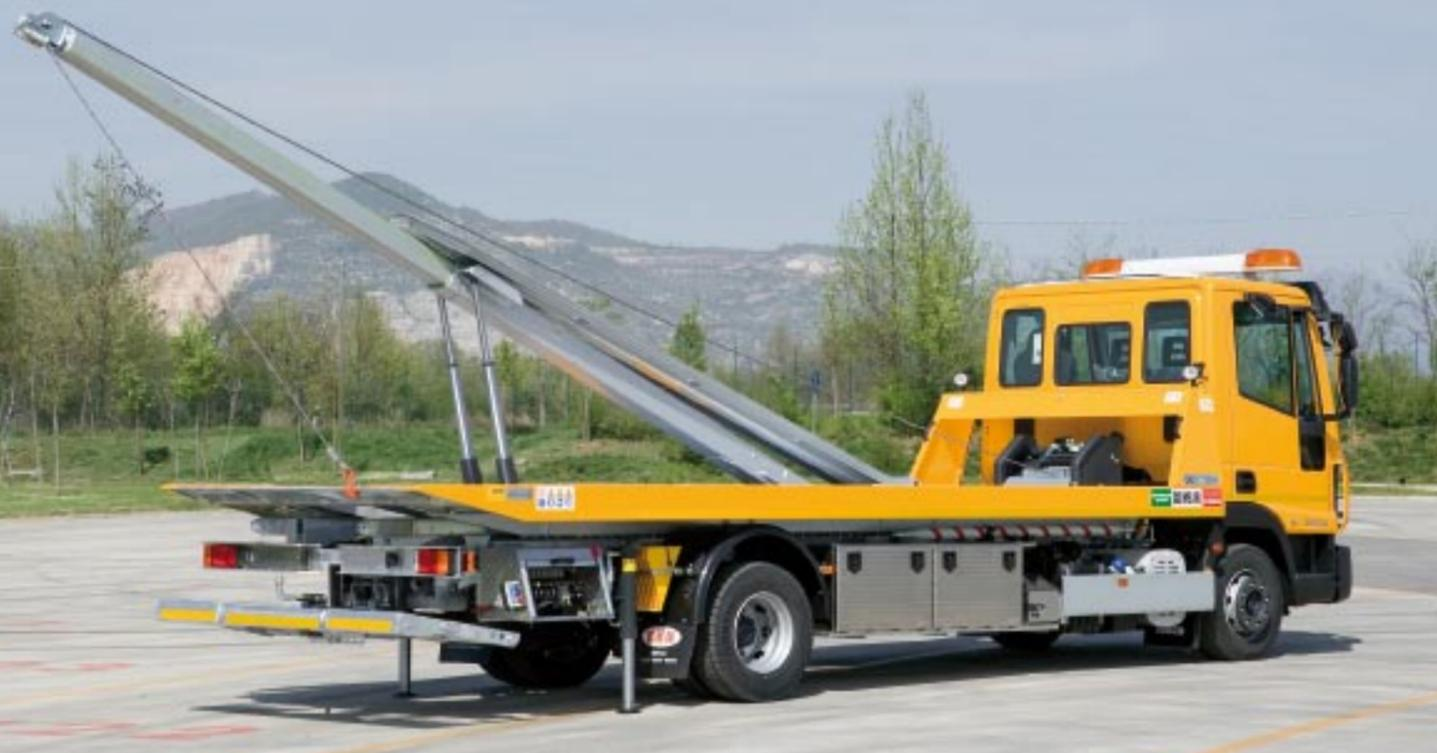
L'attrezzatura **SE 300**, derivata dell'allestimento SE 200, è applicabile su autocabinati aventi un peso totale a terra minimo di 12000 Kg ed è particolarmente adatta al recupero e al trasporto di veicoli, grazie ad una notevole facilità d'uso e alla grande stabilità durante il trasporto, garantita dalla struttura dell'allestimento, che sfrutta un falsotelaio particolarmente basso.
