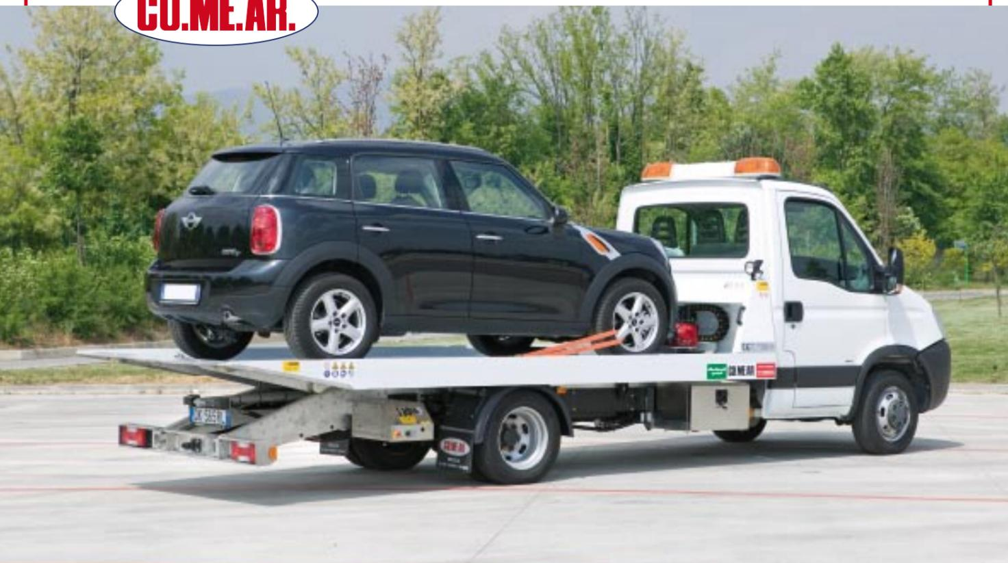
① Il **verricello idraulico** nella versione traslabile con comando idraulico facilita il carico di autovetture particolarmente incidentate.
