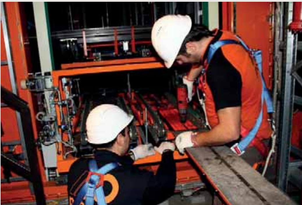
Attività di manutenzione su trasloelevatore
