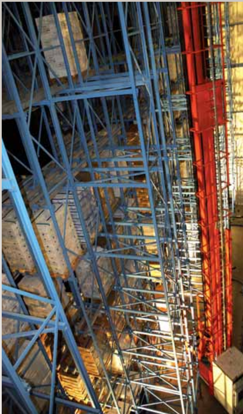
Magazzino automatico doppia profondità a temperatura controllata -28°C con trasloelevatore sterzante - settore alimentare
