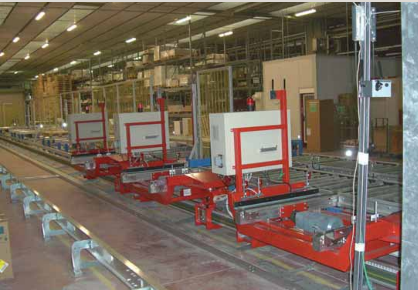
Automotori per trasporto materiale in asservimento alle zone montaggio – settore meccanico
