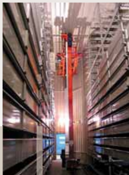
Magazzino automatico a vassoi con trasloelevatore con attrezzo di presa rotante – settore tessile
