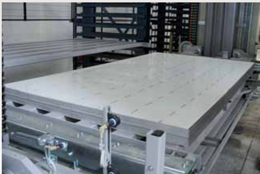
Particolare di carico con attrezzo di presa a strisciamento su trasloelevatore - settore meccanico
