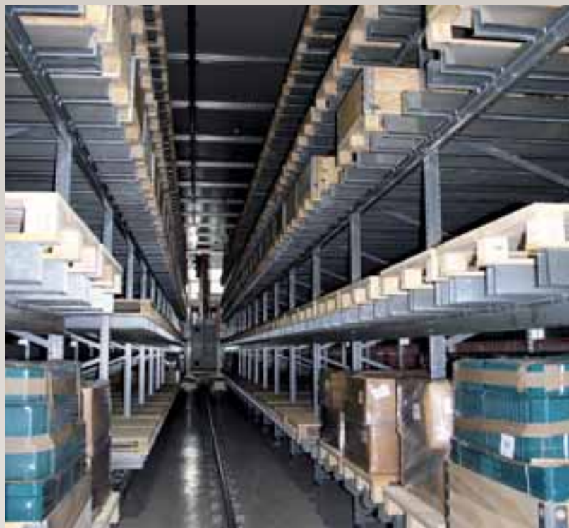
Magazzino doppia profondità per pallet – settore plastico
