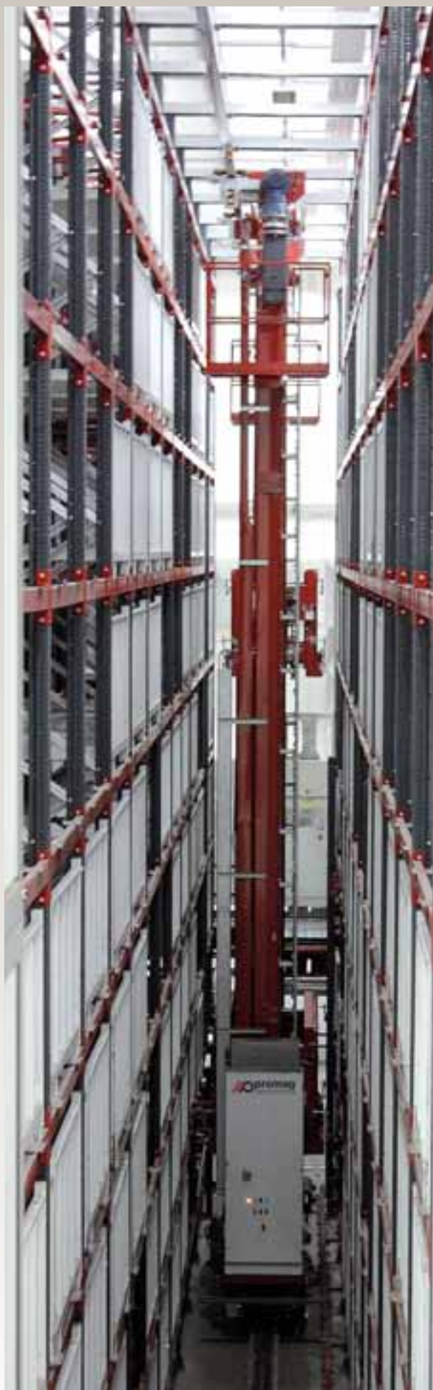
Magazzino automatico doppia profondità a temperatura controllata -28°C con trasloelevatore sterzante - settore alimentare
