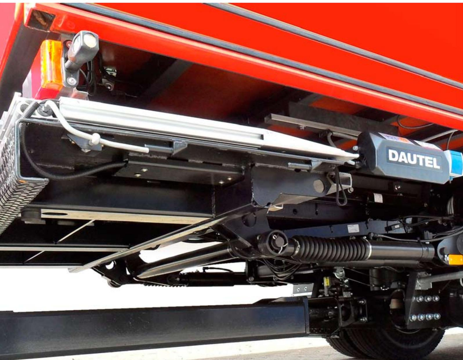
Der DAUTEL SLIDER DS 1500/2000VT vereint die wesentlichen Systemvorteile des DAUTEL SLIDER DS VA für Normalaufbauten – hohe Tragkraft, große Plattform, wartungsarme Bauweise und sichere Bedienung – mit der platz- und gewichtssparenden Bauweise des DAUTEL SLIDER DS 1500/2000VT XXL für C782 Volumen-Wechselbrücken-LKW mit Tiefkupplung bei einer Abstellhöhe von 970 mm.
